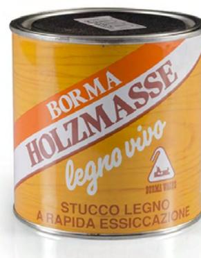
Der schnell trocknende Kitt auf Holzmehl-Basis ist gebrauchsfertig. Er wird direkt auf die vorher gesäuberte Schadstelle aufgetragen. Bei Bedarf nachspachteln. Der gehärtete Holzkitt kann wie echtes Holz geschliffen, gebeizt oder lackiert werden.
