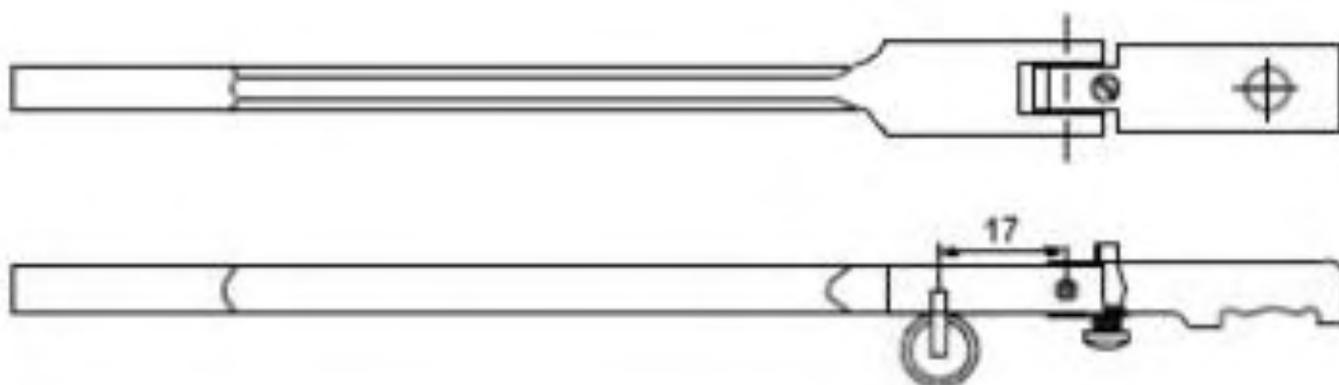
6205 5 Hammerstiele mit Rolle 10 mm  $\varnothing$  passend für Steinway Hamburg –Satz
